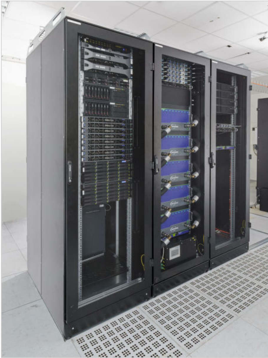
Der „Deep-Est“-Prototyp am JSC: Das Cluster-Modul besteht aus 50 Rechenknoten, die mit je zwei Intel-Prozessoren „Scalable Xeon“ bestückt und über ein Mellanox EDR-Infiniband Hochgeschwindigkeitsnetzwerk miteinander verbunden sind. Bis Jahresende sollen zwei weitere Module für paralleles Rechnen und Datenanalyse folgen. Gut erkennbar: die Flüssigkühlung von Megware. (Forschungszentrum Jülich / Ralf-Uwe Limbach)
