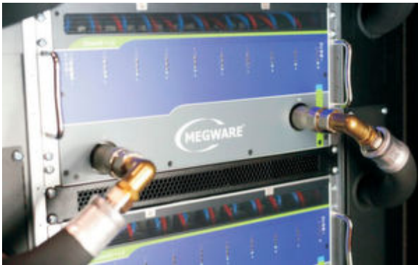
Die Megware-Direktkühlung „Coldcon“ mit Heißwasserkreislauf. (Bild: Megware)
