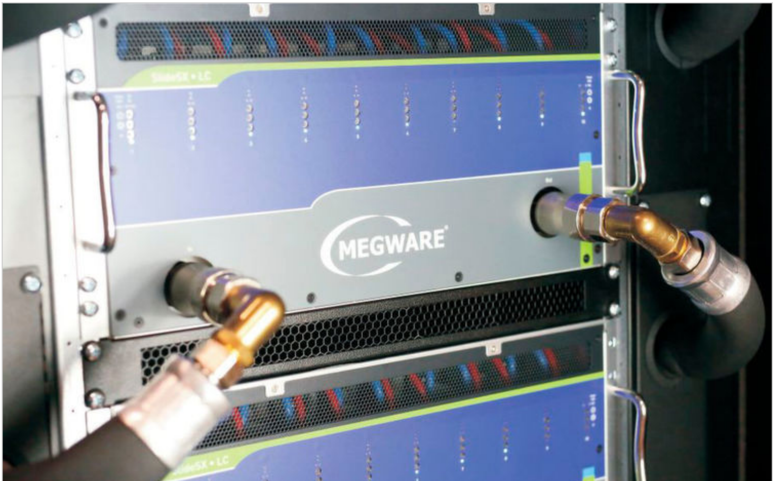
Die Megware-Direktkühlung „Coldcon“ mit Heißwasserkreislauf. (Megware)
