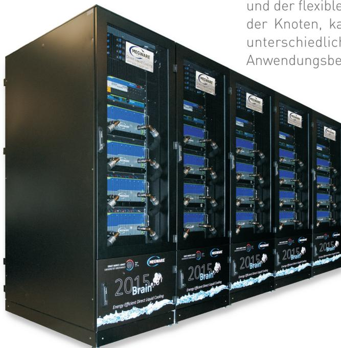
Abb.: Beispiel eines ColdCon-Systems mit direktwassergekühlten Rechenknoten an der Ernst-Moritz-Arndt-Universität Greifswald
